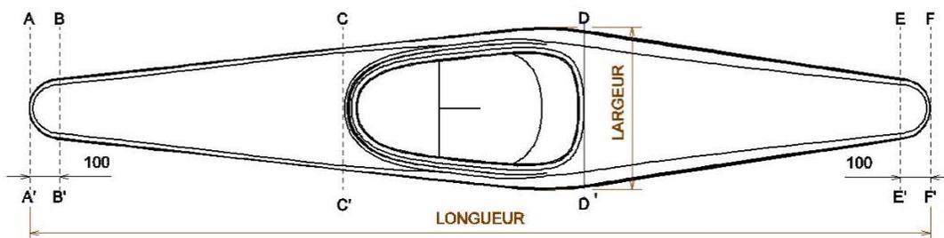
Figure 2 - Vue plane du dessus du kayak (plan x-y)
